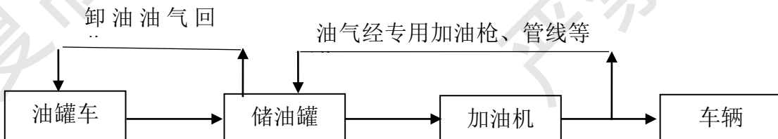
图 2-2 加油站工艺流程图
